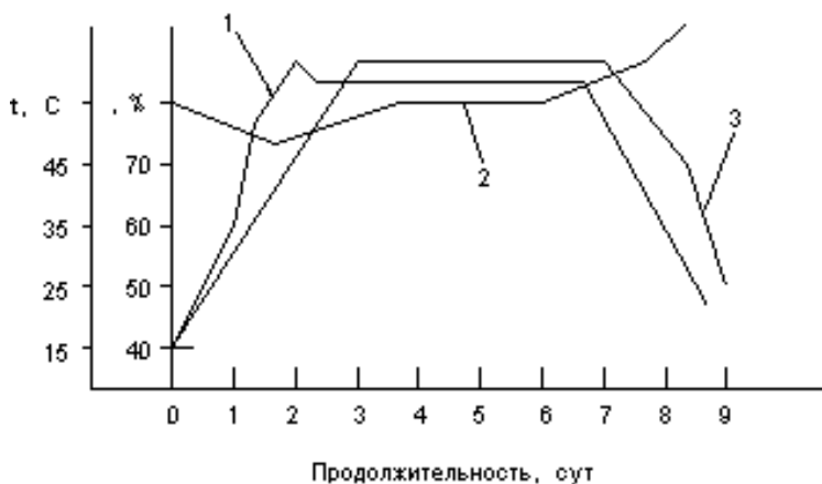
Схема 4. 1. График 50-градусного режима ферментации. 1 и 2- температура и влажность воздуха соответственно, 3- температура табака.
